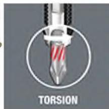
При технике кручения пики крутящего момента амортизируются в зоне скручивания насадки. Это предотвращает преждевременный износ и значительно увеличивает срок службы инструмента.
