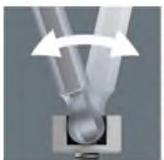
Благодаря шарообразному профилю отвода ось инструмента может отклоняться или поворачиваться относительно оси винта так, что при этом выполняется так называемое завинчивание "за угол".
