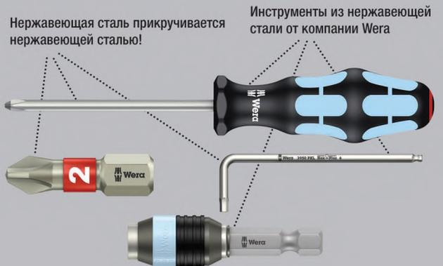
Высококачественные крестовые биты из специальной стали. Инструменты Wera Edelstahl изготавливаются из специальной стали, что исключает неприятное распространение контактной ржавчины. Шестигранный хвостовик 1/4", подходит для держателя по стандарту DIN ISO 1173-F 6,3.
