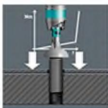
Закаленные до вязкой твердости насадки для твердых условий завинчивания, например, в жель или металл. Насадки Z, как правило, являются насадками универсального применения.
