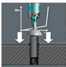
Закаленные до вязкой твердости насадки для твердых условий заворачивания, например, в жель или металл. Насадки Z, как правило, являются насадками универсального применения.
