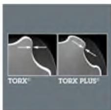
В отличие от обычного TORX® профиля увеличение 6 боковых поверхностей, передающих крутящий момент между инструментом и винтом. Увеличивается срок службы винта и инструмента.
