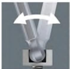
Благодаря шарообразному профилю отвода ось инструмента может отклоняться или поворачиваться относительно оси винта так, что при этом выполняется так называемое завинчивание "за угол".
