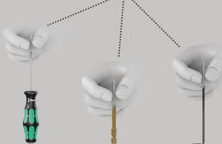
Разработанные фирмой Wera инструменты TORX® HF (HF = фиксирующая функция) отличаются улучшенной геометрией исходного профиля TORX®. За счёт прижимной силы, возникающей в результате контактного давления между наконечником инструмента и профилем головки винта, винты надёжно удерживаются на инструменте! Шестигранный хвостовик 1/4", подходит для держателя по стандарту DIN ISO 1173-F 6,3.
