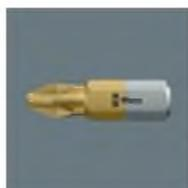
При серийном завинчивании насадки подвергаются чрезвычайным длительным нагрузкам. Для этих целей на насадки с закалкой до вязкой твердости наносится сверхтвердое износостойкое покрытие из нитрида титана.
