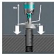
Насадки, закаленные до вязкой твердости, препятствуют преждевременному разрушению ведомого наконечника. В каталоге можно распознать по букве Z в обозначении изделия. Насадки Z, как правило, являются насадками универсального применения.
