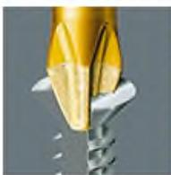
С алмазным покрытием для уменьшения опасности соскальзывания. Мельчайшие алмазные частицы на острие насадки практически "вгрызаются" в винт. DC означает Diamond Coated (алмазное покрытие).
