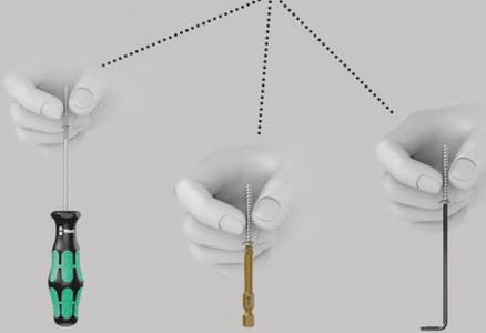
Высококачественные биты TORX®. За счёт прижимной силы, возникающей в результате контактного давления между наконечником инструмента и профилем головки винта, винты надёжно удерживаются на инструменте. Шестигранный хвостовик 1/4", подходит для держателя по стандарту DIN ISO 1173-D 6,3.
