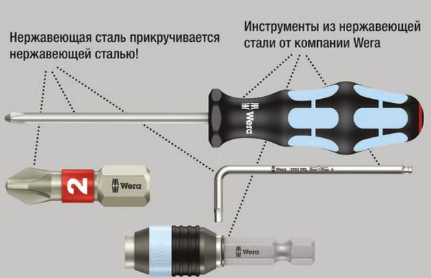
Высококачественные биты Pozidriv из специальной стали. Инструменты Wera Edelmetall изготавливаются из специальной стали, что исключает неприятное распространение контактной ржавчины. Шестигранный хвостовик 1/4", подходит для держателя по стандарту DIN ISO 1173-F 6,3.
