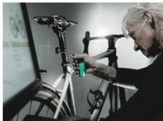
Динамометрический индикатор с фиксированным моментом затяжки и с защитой от вмешательства в настройки
