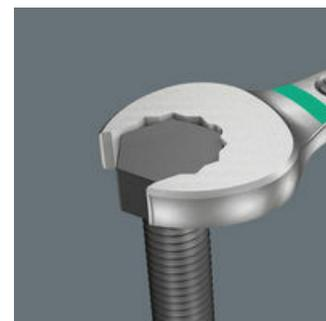
Профиль в виде двойного шестигранника в рожковой и накидной частях обеспечивает плотный захват головки винта или гайки и снижает вероятность соскальзывания.
