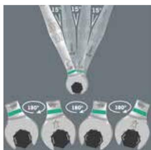
Благодаря наклону на  $7,5^\circ$  рожковой части, профилю в виде двойного шестигранника и оптимальному способу работы (накинуть – закрутить – вернуть – снова накинуть – закрутить – вернуть и т.д.) закручивать можно в тех случаях, когда для поворота ключом имеется угол меньше  $30^\circ$ .
