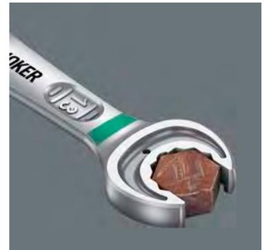
Умная геометрия двойного шестигранника Joker обеспечивает геометрическое замыкание с болтом или гайкой. А сменная, закаленная металлическая пластина в зеве Joker вцепляется очень прочными зубцами в болт. Все это предупреждает неприятное соскальзывание даже при больших моментах затяжки.
