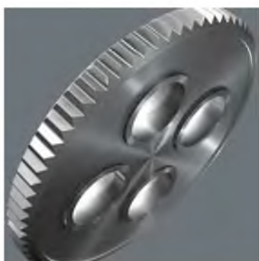
Zyklop Metal Switch Реверсные трещотки с 72 мелкими зубцами имеют небольшой угол возврата – всего 5°. Небольшой ход трещотки позволяет работать быстро и точно в любых положениях.
